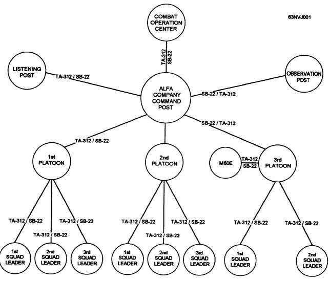
Figure 2-1.—Company CP wire plan.
